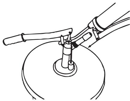
Fettpresse mit Füllnippel auf das Füllventil des Fettpressenfüllgerätes aufsetzen und mit leichtem Gegendruck halten.
