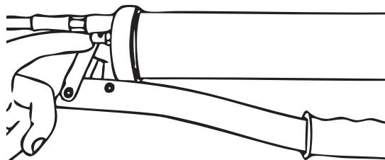
Entlüften des Fettbereichs über den kombinierten Füll-/ Entlüftungsnippel am Fettpressenkopf, durch Lösen von Pressenkopf- und Rohr (max.  $\frac{1}{2}$  Umdrehungen) oder durch mehrmaliges Betätigen des Handhebels.
