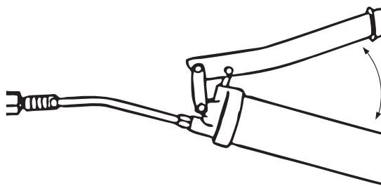
Durch Betätigen des Handhebels den Abschmievorgang ausführen.
