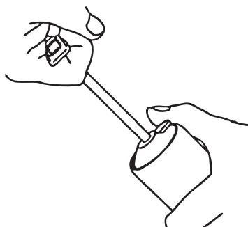
Unter Zug der Schubstange, die Sperrklinke betätigen, und die Schubstange wieder in das Rohr schieben.
