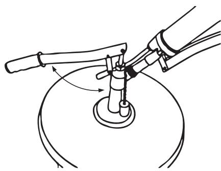
Durch Betätigen des Füllgerätes die Fettpresse befüllen.
