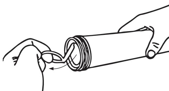
Erst dann den „Pull-off“-Verschluss der Kartusche abreißen und den Fettpressenkopf aufschrauben.
