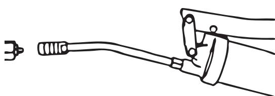
Fettpresse mit dem Hydraulik-Mundstück auf den Schmiernippel aufsetzen.
